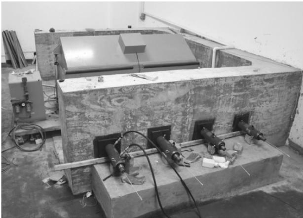
(a) 拉索荷载-盐雾锈蚀耦合试验系统
