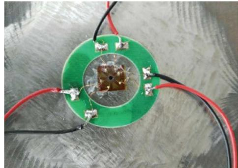
图 2 钻孔后的应变片
