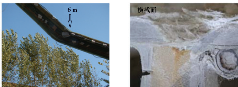
图 7 叶片断裂失效外形图 Fig.7 Fracture failure profile of the blade
