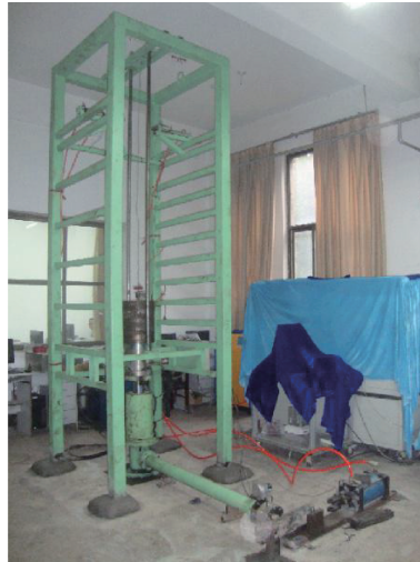
图 2 动静载条件下煤与瓦斯突出模拟实验装置图
