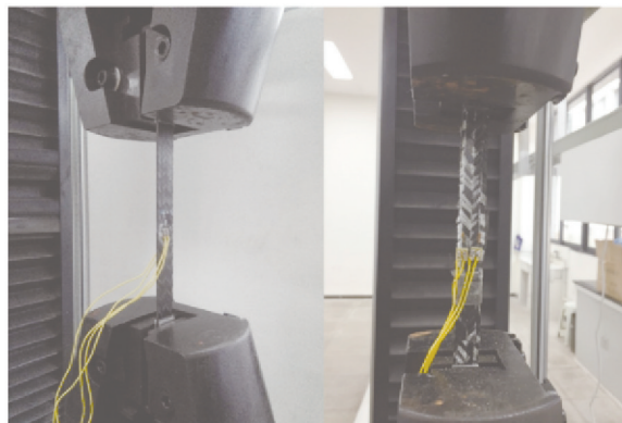
图 5 轴向拉伸实验示意图
