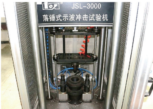
图 2 低速冲击试验装置 Fig. 2 Setup for impact test
