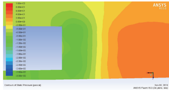
(b) 加装驾驶室前部仿生减阻结构模型
