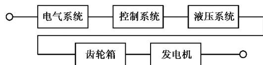
图 2 风电机组可靠性框图
