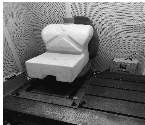
图 8 汽车座椅水平调节器运行状态
