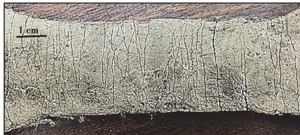
图 5 拉伸荷载下 ECC 的开裂形态
