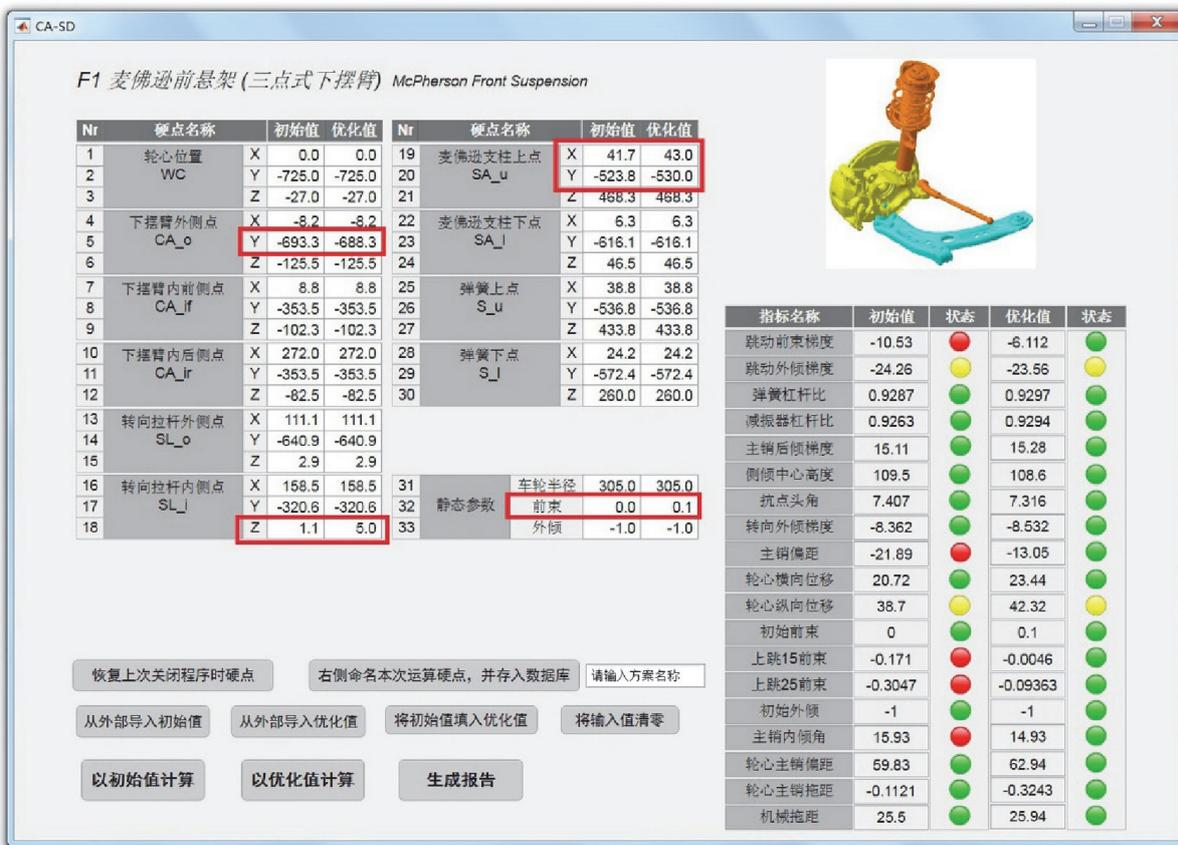
图 3 硬点设计模块(CASD),麦佛逊前悬架设计示例
