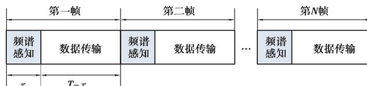
图 2 CRAHN 系统时隙结构图
