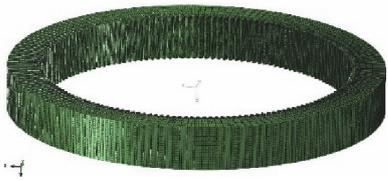
图 1 传统内齿圈有限元模型
