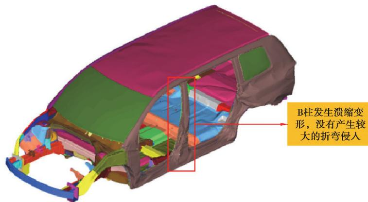
图 20 减质量后的 MDB 工况车身变形
