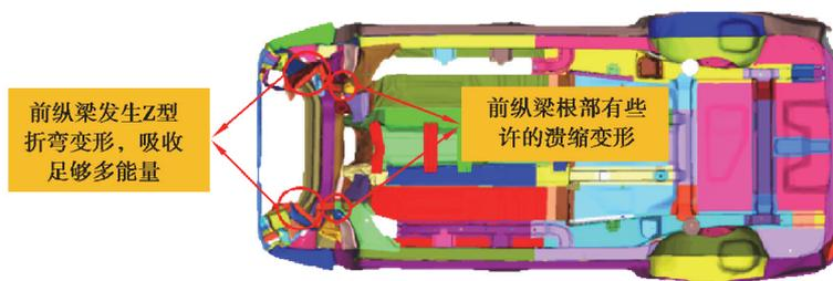
图 18 减质量后的 FRB 工况车身变形
