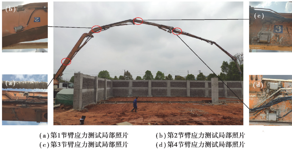
图 13 应力测试现场照片
