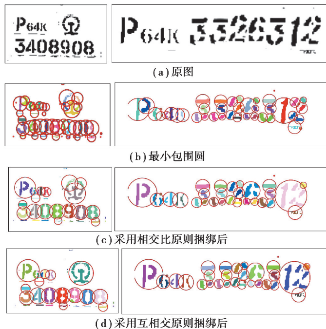
图 8 货车车号分割过程示例
