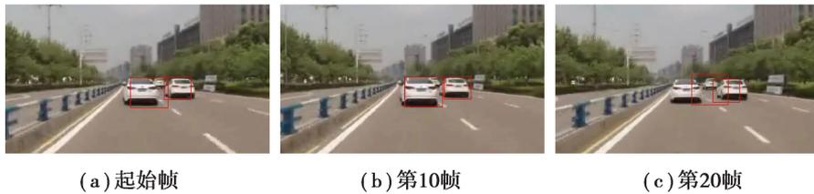
图5 基于标准粒子滤波算法的车辆跟踪
