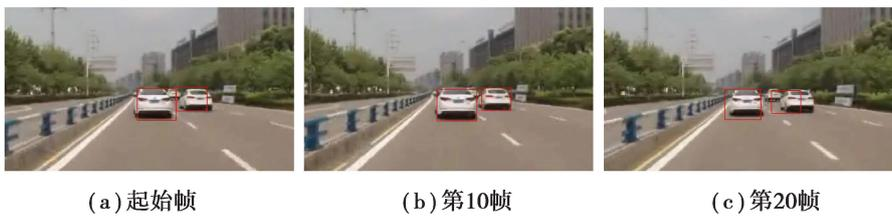
图6 基于改进粒子滤波算法的车辆跟踪
