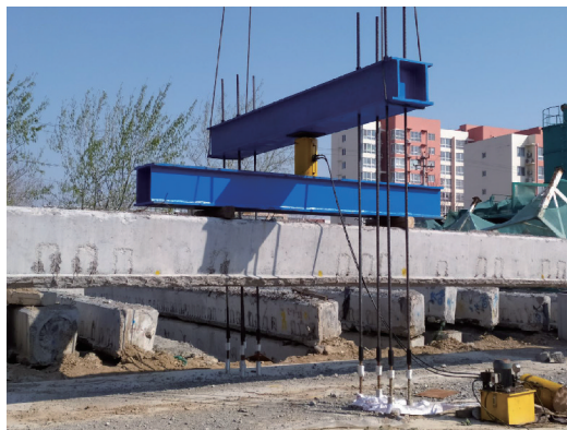
图 8 极限承载能力试验
