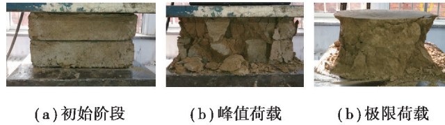
图 7 干打土坯试件破坏过程
