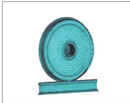
图1 轮轨接触有限元模型
