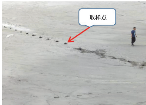
图 13 尾矿库干滩面取样
