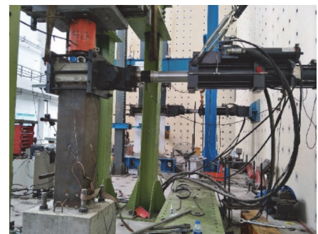
图 3 桥墩试件加载装置
