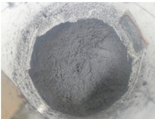
图 3 定形相变材料样本图
