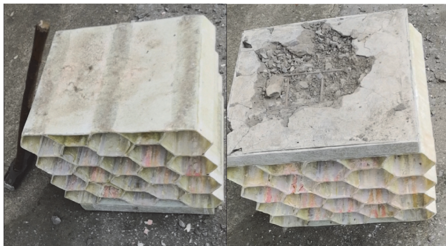
图2 FRP板与混凝土板连续敲击20次后破坏对比
