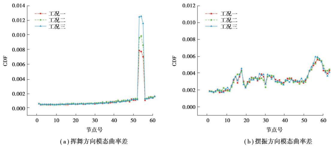
图 12 叶片不同损伤工况下模态曲率差
