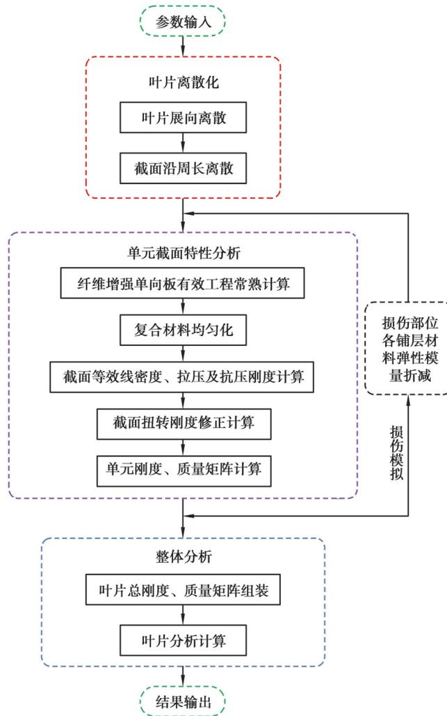
图 5 叶片快速建模损伤模拟流程
