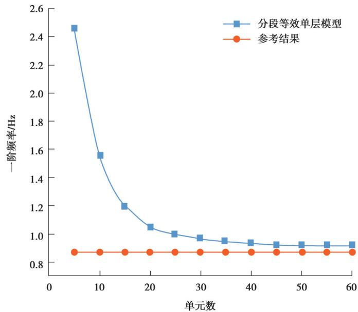
图8 叶片一阶固有频率随单元数变化
