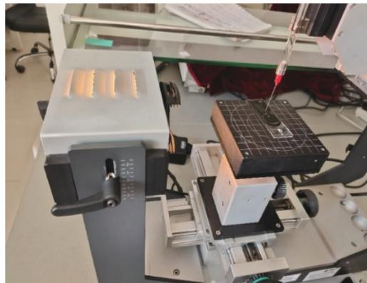
图2 接触角测定
