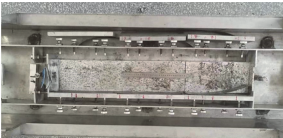
图 3 加速加载试验槽
