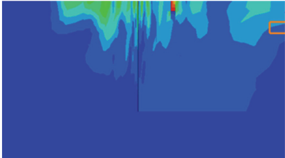
图 9 裂缝扩展至顶面 Fig. 9 Cracks spread to the top surface
