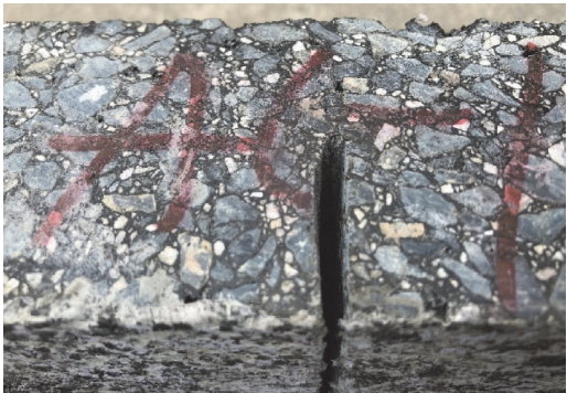
图 6 作用 14 万次后的试件 Fig. 6 Specimen after 140,000 actions
