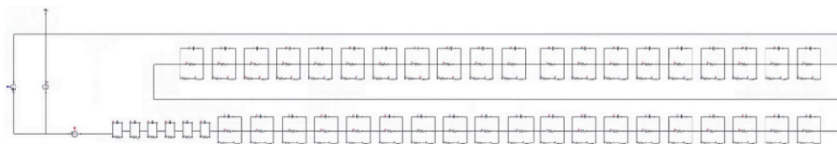
图 8 电机单相差模阻抗电路模型
