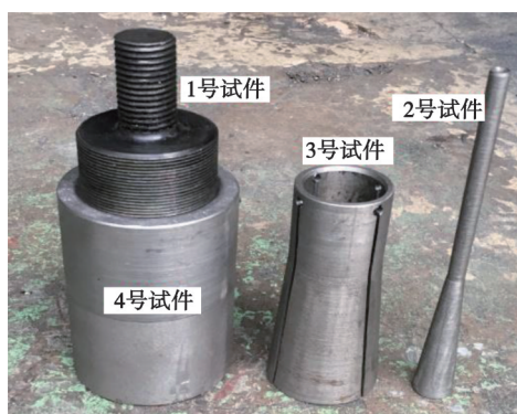
图2 铝绞线拉伸夹具实物图
