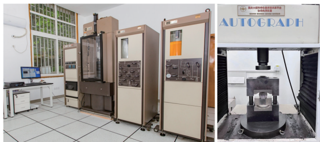
图9 MTS815三轴试验机与岛津试验机
