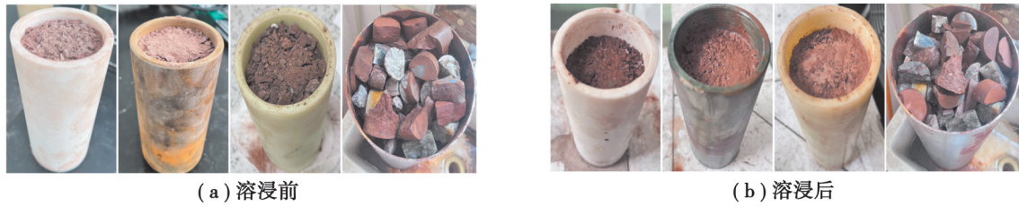
图4 溶浸后溶缩稳定状态
