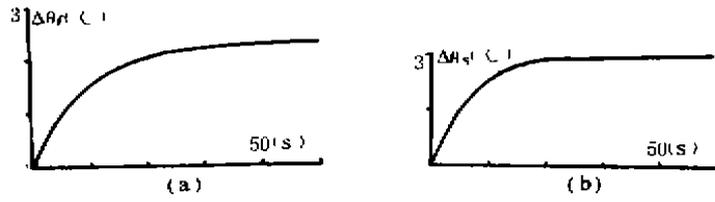
图2 加热器给水流量减少10%时, (a)给水出口温度, (b)加热器饱和蒸汽温度的响应。
