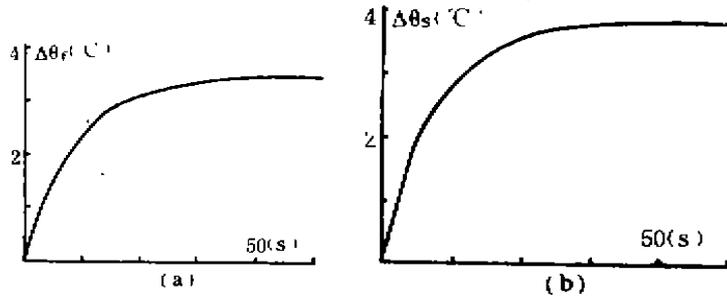
图3 加热器给水进口温度增加 $10^{\circ}\text{C}$ 时, (a)给水出口温度, (b)加热器饱和蒸汽温度的响应。
