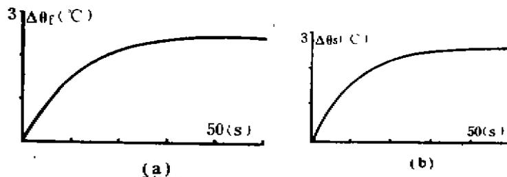
图5 加热器抽汽量增加10%时, (a)给水出口温度, (b)加热器饱和蒸汽温度的响应。
