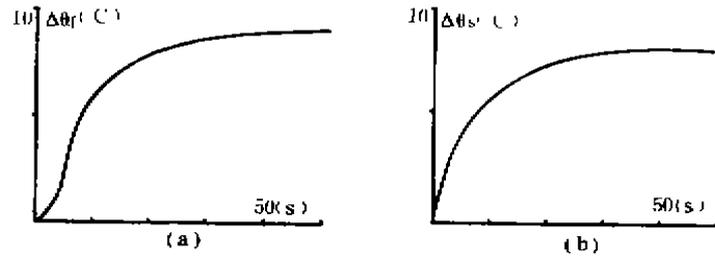
图4 加热器抽汽焓增加10%时, (a)给水出口温度, (b)加热器饱和蒸汽温度的响应。
