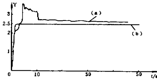
图 4 网络第一次学习时系统响应曲线与多次学习后的响应曲线
