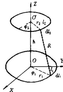
图 1 二平行共轴载流圆线圈
