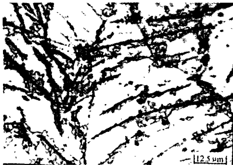
图 8 氢含量 361 ppm 的金相组织
