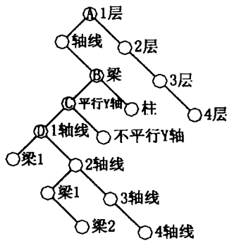
图 3 工程结构 CAD 树存储结构图
