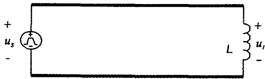
图2 终端接电感的传输线系统
