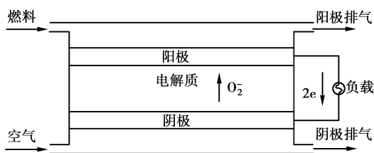
图 3 SOFC 工作原理
