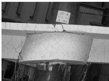
(b)斜柱环梁节点低调反复加载试验 (GJ-6)
