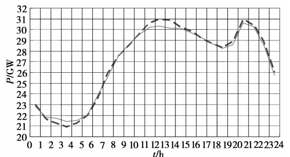
图 6 负荷预测曲线与实际负荷曲线对比图
