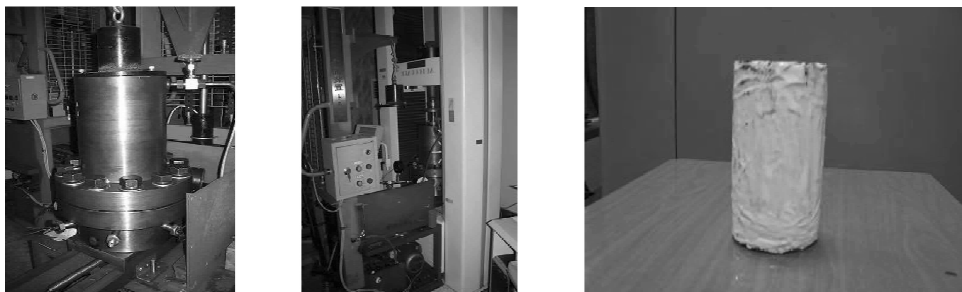
图1 含瓦斯煤岩常规三轴试验设备及试件
