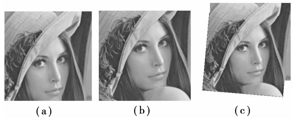
图 2 (a)是从 512 \times 512 的标准 Lena 图像中剪切出的一幅 256 \times 256 的图像,(b)是从旋转 11^\circ 的相同的 Lena 图像中剪切出的一幅 256 \times 256 的图像, (c)是用提出的算法进行配准后拼接而成的图像。
