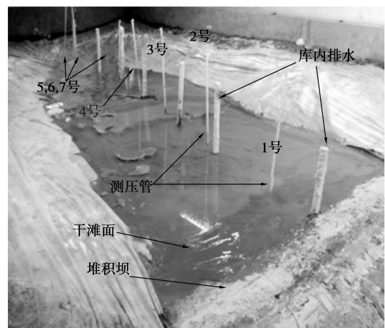
图2 堆坝模型在洪水工况下的情况
