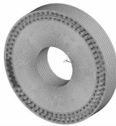
图 4 内啮合齿轮副三维有限元接触模型
