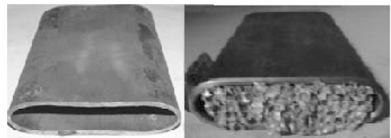
图9 空钢管与泡沫铝填充管压缩变形图
