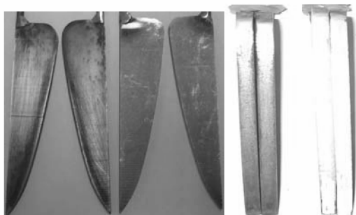
图7 电极腐蚀形状图
