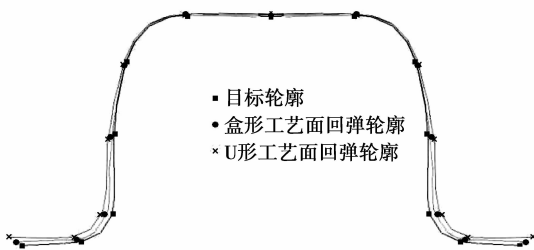
图 8 两种工艺补充面纵向截面回弹量对比
