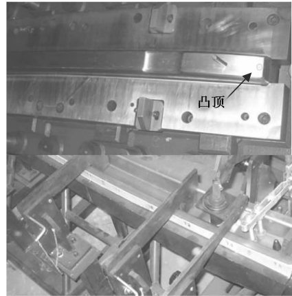
图 14 凸模型面及检具上的合格零件
