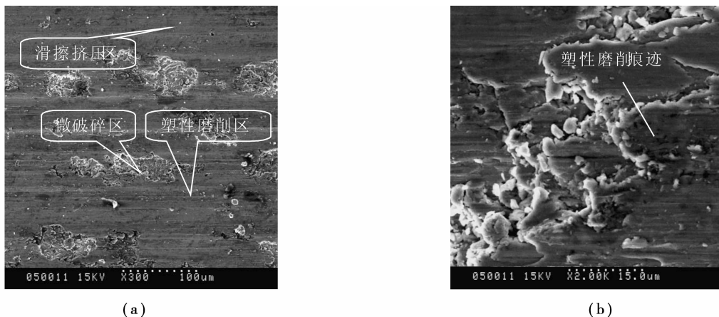
图 4 轴向超声振动辅助磨削加工表面微观形貌
