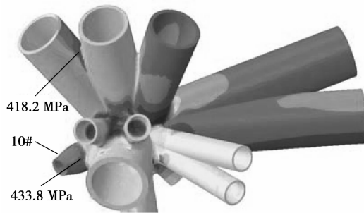
图 5 铸钢节点极限荷载下 Mises 应力
