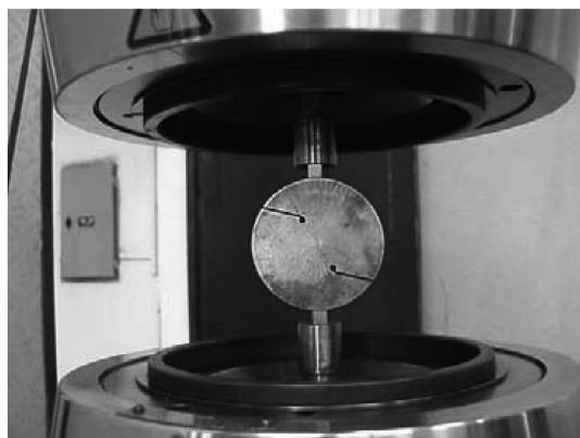
图 4 组合圆盘试验情景照片
