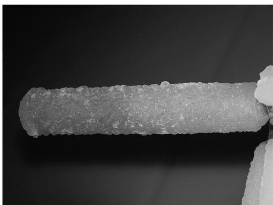
图 1 监测覆冰厚度的旋转导体
